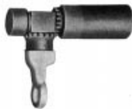
Capa da culatra dentada PN 306347-1 Adaptada ao bastão de manobras, permite que a unidade de força seja apertada contra a cunha pela simples rotação do bastão
