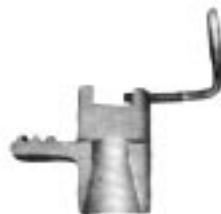
Porta Cunha PN 306348-1 Usado para prender a cunha no bastão de manobras e posicioná-la no "C"
